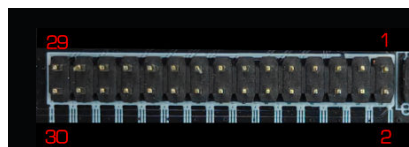
Conector LVDS de 30 pines visto de frente. Pines 1 y 2 a la derecha, 29 y 30 a la izquierda.
